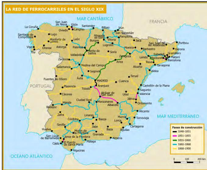
Por el color del trazo se puede conocer las fechas de construcción de los distintos tramos del ferrocarril en España. A esta red, cerca del año 1900, le faltaban bastantes kilómetros para completar la red básica esencial que hubiera permitido el necesario desarrollo industrial. No debe olvidarse que, a la fecha de este mapa, el ferrocarril era el único medio capaz de suministrar un transporte eficaz.
